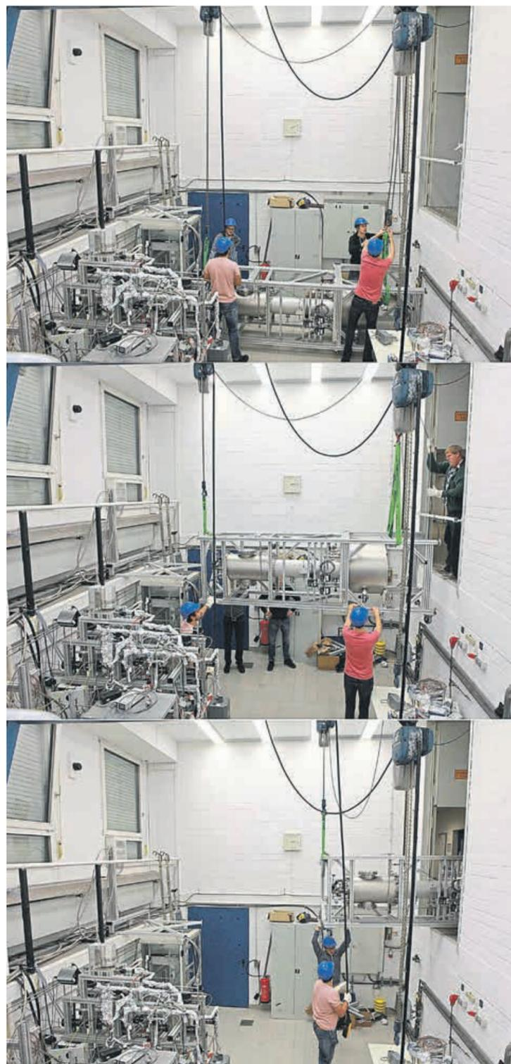
Die kryogene Destillationssäule musste in Münster erst abgebaut werden, bevor sie auf Fahrt nach Italien ging. Foto: Sergej Schneider
